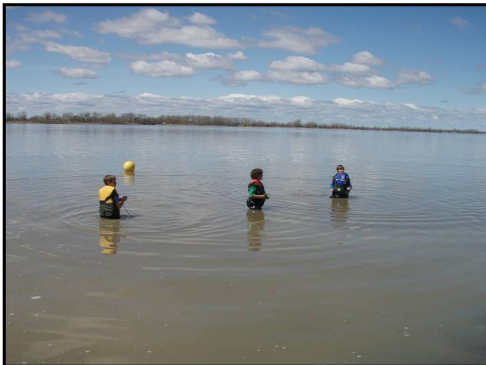
Figure 8. Les élèves mesurent la vitesse du courant au site 2 à l'aide d'une balle de tennis et d'un chronomètre.
